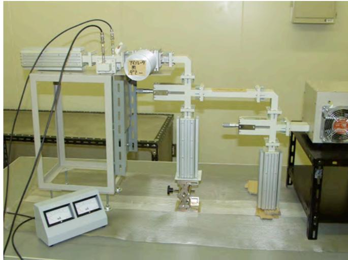
図4.1-1 マイクロ波発振確認実験装置外観
